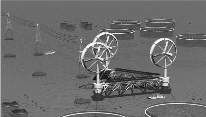
図-18 新しいコンセプトの洋上浮体式エネルギーファーム（風力と太陽光）CG。周辺に自動給餌器、魚・海的环境監視システムを備えたスマート養殖施設を配備。
